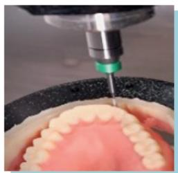
Usinage de la prothèse dans un laboratoire certifié
